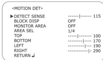
Этот продукт имеет функцию, которая позволяет наблюдать движение объектов в выбранной области на экране.
