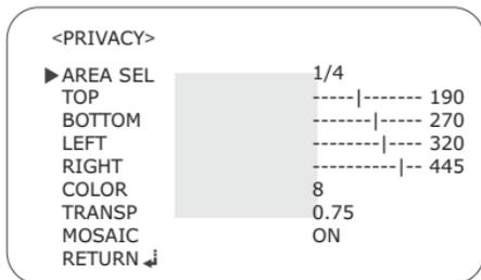
**AREASEL:** Есть 4 ОБЛАСТИ. Пользователь может настроить размер области, нажимая переключатель в четырех направлениях. И выбранные области могут отображаться на экране в то же время.
