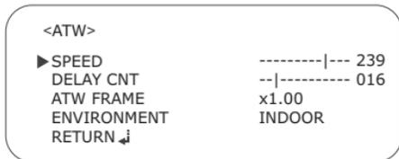
Диапазон регулирования **SPEED** и **DELAY CNT** составляет от 0 до 255. Переместите курсор на **ATWF RAME**, нажмите кнопку **LEFT** или **RIGHT** переключателя для выбора одного из четырех режимов: × **0.50**, × **1.00**, × **1.50** и × **2.00**. Нажмите **LEFT** или **RIGHT** переключателя для выбора режима **ENVIRONMENT**, для него существует два значения: **INDOOR** и **OUTDOOR**.
