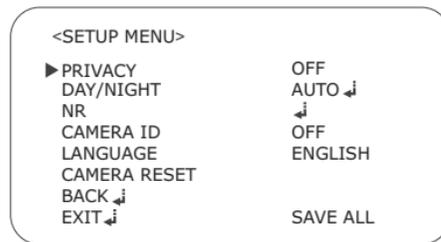
Когда для функции **PRIVACY** выбрано значение **ON**, квадратная рамка отобразится на экране. Нажмите центральную кнопку переключателя, и следующее подменю отобразится на экране:
