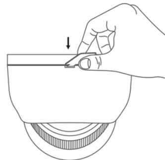
С помощью тонкой отвертки, подденьте край крышки купола, и он легко отделится от основания.
