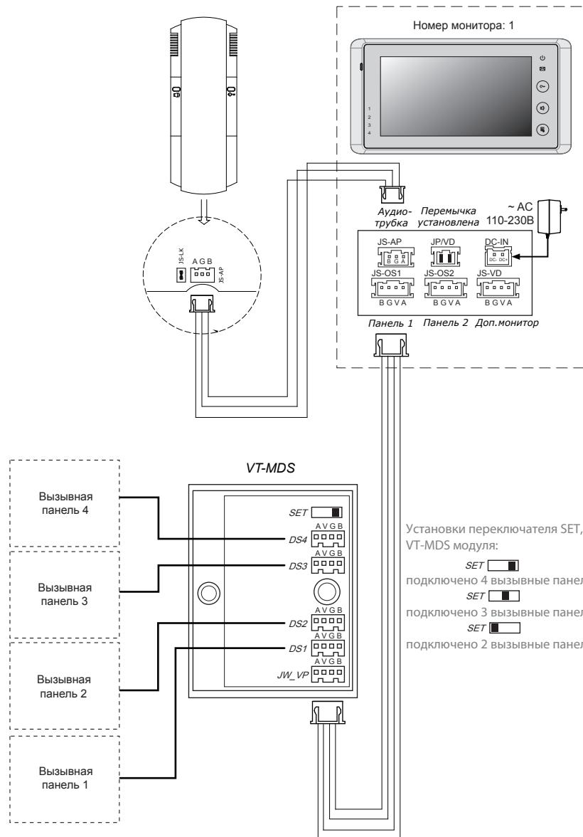
Схема подключения 4-х вызывных панелей с использованием дополнительного VT-MDS модуля а также аудиотрубки (модуль и аудиотрубка в комплект домофона не входят).
